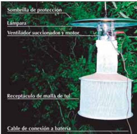
Fig. 41. Trampa CDC adaptada a la captura de ejemplares vivos.
