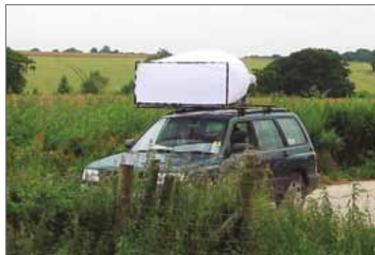
Fig. 40. Trampa casera de tela construida sobre el techo de un coche para capturar los mosquitos en transectos.
