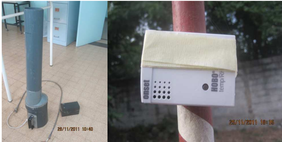
Figure 28 : Aspirateur avec batterie de 12volts à gauche et un enregistreur de température et d'humidité relative de type HOBO à droite (Cliché : DUSOM M.).
