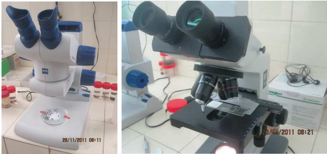
Figure 29 : Loupe binoculaire à gauche et microscope à camera intégrée à droite (Cliché : DUSOM M.)
