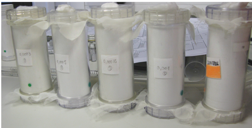
Figure 2.1 Tubes OMS d'exposition contenant les papiers imprégnés d'insecticide et placés en position verticale
