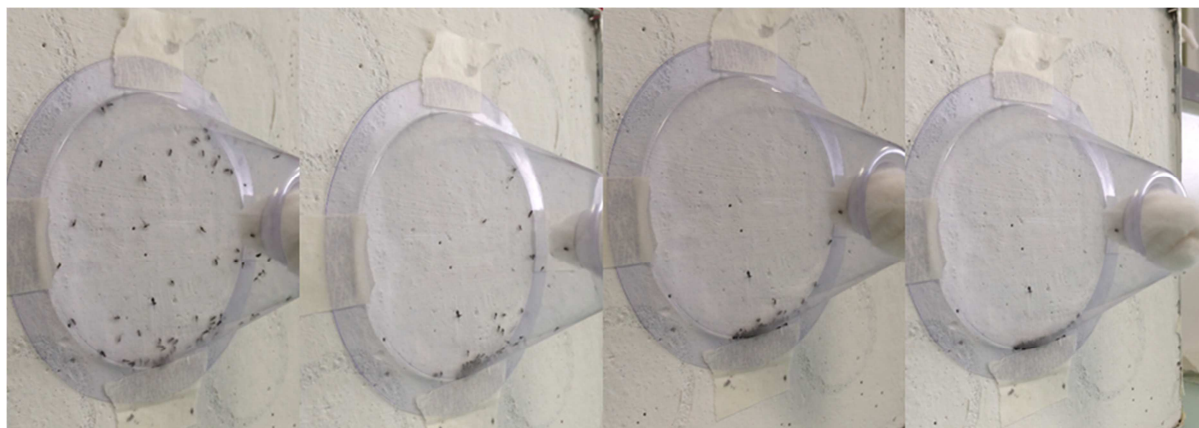
Figure 4.5 Visualisation de l'effet Knock Down causé par la peinture insecticide, appliquée sur un support en béton, à des individus Culicoides nubeculosus lors de test en cône OMS. Cinq minutes séparent les prises de vue (de gauche à droite), la première étant prise immédiatement après la mise en contact.
