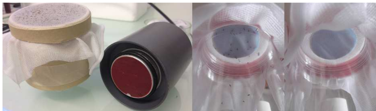
Figure 3.2 Dispositifs pour évaluer l'inhibition de repas sur les Culicoides avec des répulsifs, membrane sur la pastille de sang (à gauche) et pastille de papier filtre non traitée (au centre) et traitée avec du géranium (à droite).
